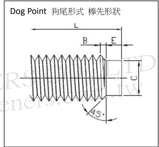
Material 材質 : Steel 鋼 スチール (MFHFH) / Stainless Steel 不鏽鋼 ステンレス鋼 (MFHFHS)
